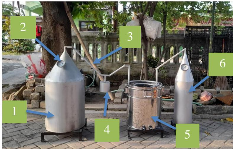
Gambar 2. Hasil Pembuatan *prototype* alat produksi asap cair
