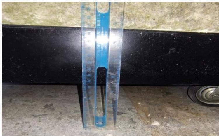
Gambar 3.13 tinggi troli dengan uji beban tekan 245kg
