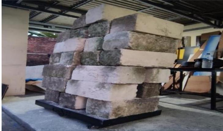
Gambar 3.14 troli dengan uji beban tekan tinggi 875kg
