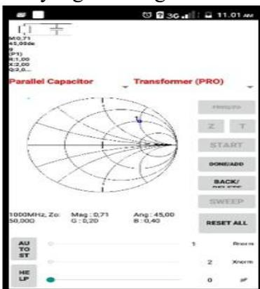
Gambar 6. Hasil dengan elemen paralel kapasitor
